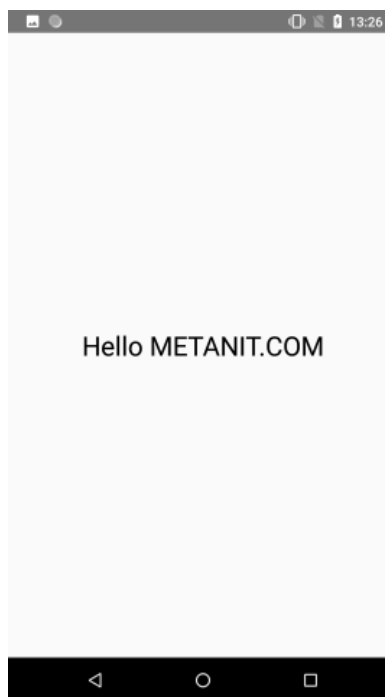
Рисунок 5.2 – Использование свойства позиционирования Alignment.Center Контейнер Column позволяет выстроить вложенные компоненты в столбик. Функция Column принимает четыре параметра:
